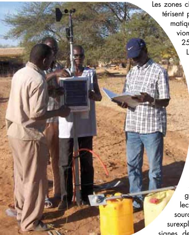
Installation d'une station météorologique automatique au Sénégal. Cette station enregistre 250 données journalières sur la température, l'humidité relative, le vent, la pluviométrie, le rayonnement solaire et l'évapotranspiration.
