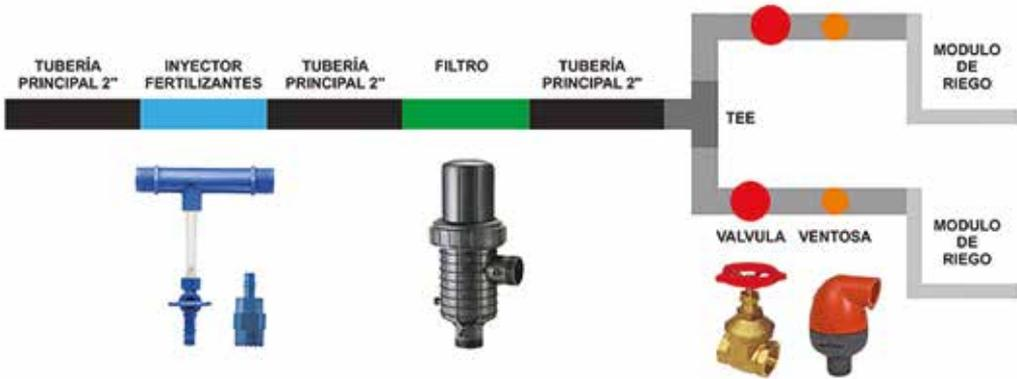
**Figura 4:** Diseño y fotografías del cabezal de riego por goteo. Fuente: [www.hidrequipos.com.co/](http://www.hidrequipos.com.co/)
