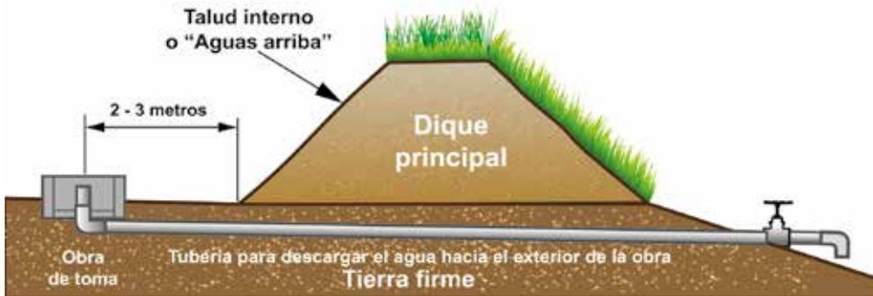
**Figura 5.** Corte lateral para indicar la ubicación recomendada de la obra de toma y de la tubería de drenaje. Fuente: CATIE.
