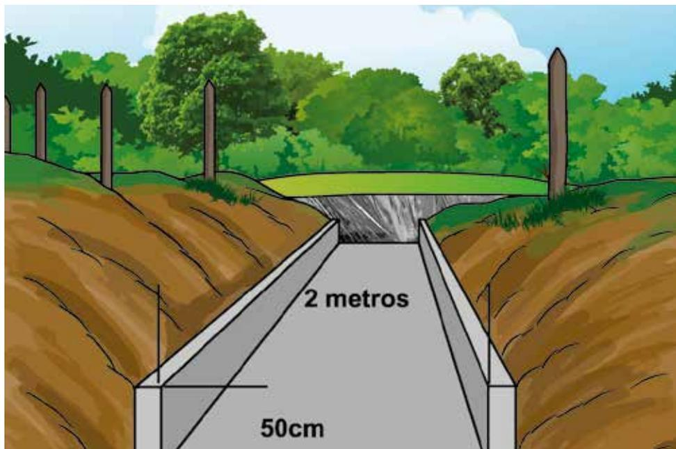
**Figura 7.** Diseño del vertedero con 2 m de ancho por 50 cm de profundidad, utilizando concreto y piedra de río. Fuente: CATIE.
