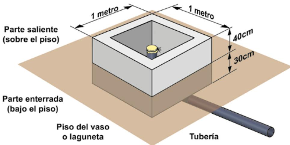
Figura 4. Diseño de la obra de toma con las medidas más utilizadas en Centroamérica. Fuente: CATIE.
