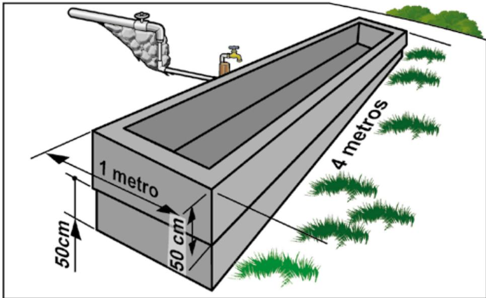
Figura 9. Diseño del abrevadero para diez cabezas de ganado. Fuente: CATIE.
