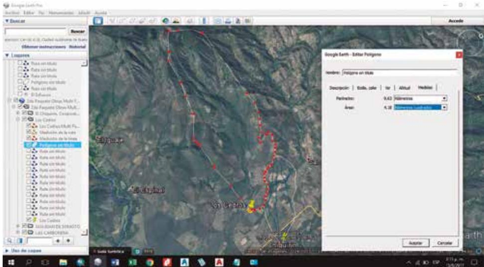
**Figura 15.** Ejemplo del trazo del área de recarga y de la ubicación del sitio de construcción del reservorio. El comando “Editar Polígono” permite hacer cambios en todos los trazos. Fuente: Google.
