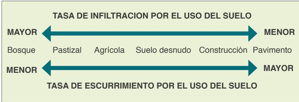
**Figura 3.** Muestra gráfica de la tasa de infiltración y escurrimiento, según el uso del suelo. Fuente: CATIE.
