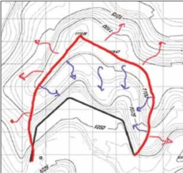
**Figura 14.** Ejemplo de ilustración mostrando la demarcación de una cuenca hidrográfica. En esta figura, la cuenca tributa no a un punto, sino a una línea. Fuente: CATIE.
