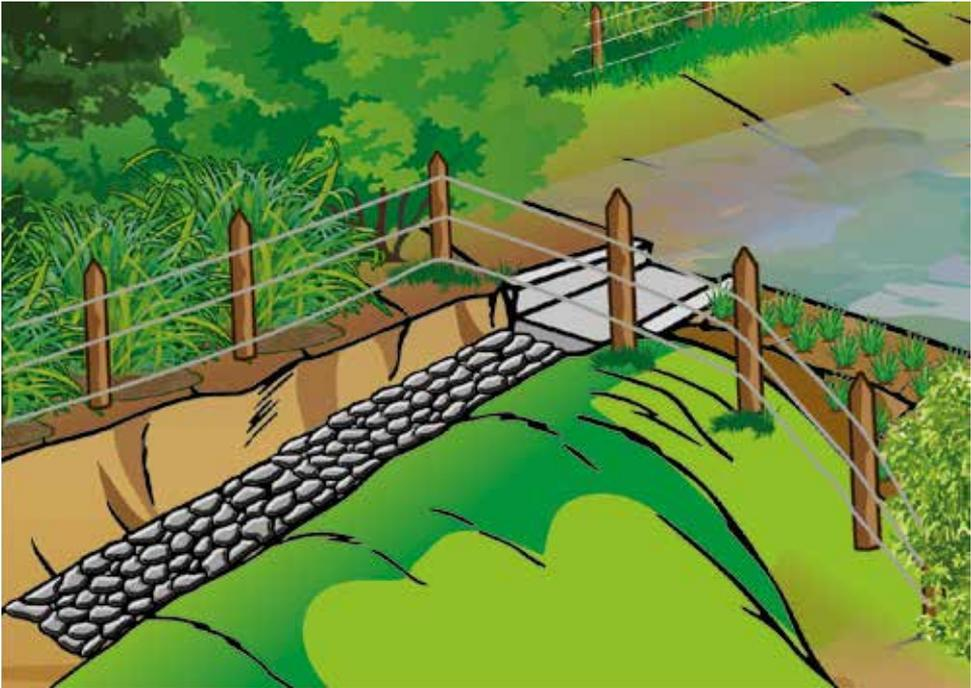
**Figura 8.** Uso de piedra de río para extender el largo del vertedero con el fin de evacuar excedentes. Fuente: CATIE.
