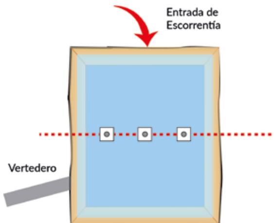
**Figura 6.** Ejemplo de posibles puntos de ubicación de la obra de toma en un reservorio trapezoidal con fondo horizontal o con el punto más bajo hacia el medio. Fuente: CATIE.
