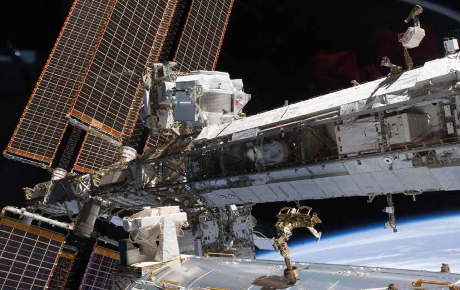
Das Alpha-Magnet-Spektrometer installiert auf der Traverse der Internationalen Raumstation ISS © NASA
