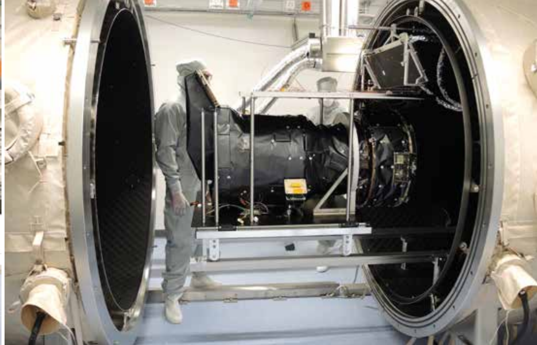
Das CHEOPS-Struktur- und -Wärmemodell (STM) im Labor an der Universität Bern. Links die Ansicht von vorne mit dem Schutzschirm und oben die Radiatoren die die Wärme der Elektronik abstrahlen und damit für eine konstante Temperatur sorgen. Rechts wird das Teleskop in den thermischen Vakuumbehälter geschoben für Umwelttests. © CHEOPS Team / Universität Bern
